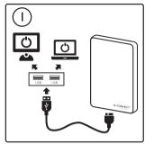
I. Schalten Sie Ihren Computer ein und verbinden Sie das externe Festplattenlaufwerk, über das beiliegende USB 3.0-Datenkabel, mit einem USB 3.0 Anschluss Ihres Computers.
