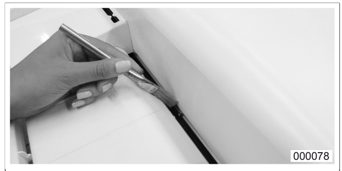
fig. 7 Nettoyage des cellules photoélectriques
