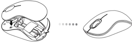
4. Setzen Sie die Batterieabdeckung wieder ein. Passen Sie die Abdeckung vorsichtig ein, bis sie einrastet.
