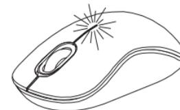
Het lampje licht op van de naad tussen de linker -en rechtermuisknop. Het zal aangaan wanneer de stroom laag is en de batterijen vervangen moeten worden.
