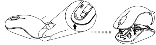
2. Klipsin ortasına bastırıp geriye, farenin arkasına doğru kaydırarak pil güvenlik klipsini çıkarın. Klipsi yukarı kaldırın ve döndürün.
