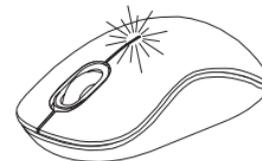
Le faisceau devient visible dans l'interstice séparant le bouton gauche du bouton droit lorsque le niveau de charge des piles devient insuffisant.
