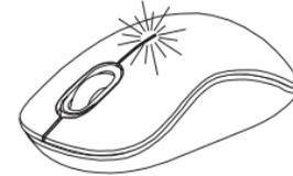
Sağ ve sol düğmelerin arasındaki ışık yanar.. Güç azaldığında be pillerin değiştirilmesi gerektiğinde ışık yanar.
