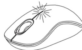
A luz ilumina a linha de junção entre os botões esquerdo e direito. Liga-se quando a potência das pilhas é fraca e necessitam de ser substituídas.
