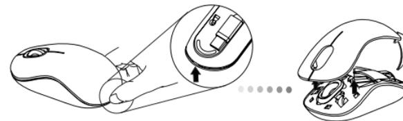
2. Нажмите на среднюю часть предохранительного зажима для батарей и сдвиньте его в сторону задней части мыши. Поднимите и поверните зажим в сторону.
