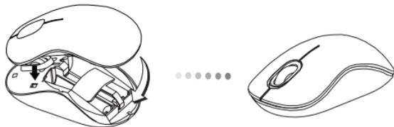
4. Установите на место крышку отсека для батарей и зафиксируйте со щелчком.
