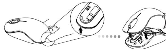
2. Zdjąć zatrzask zabezpieczający baterię wciskając jego środkową część i przesuwając go w kierunku tylnej części urządzenia. Następnie podnieść i przekrócić zatrzask.
