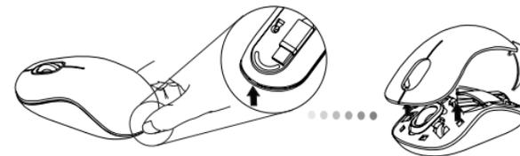
2. Ta bort batteriets säkerhetsklämmor genom att pressa mot klämmornas mitt och skjut därefter tillbaka dessa mot musens baksidan. Lyft upp och rotera klämmorna så de sätts ur spår.
