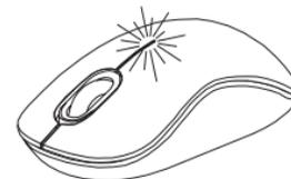
Indikátor svieti v priestore medzi ľavým a pravým tlačidlom. Indikátor sa rozsvieti, ak sú batérie vybité a je potrebné ich vymeniť.
