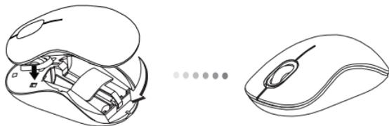
4. Refermez le couvercle du compartiment de piles jusqu'à entendre le clic de verrouillage.
