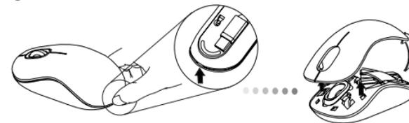
2. Retire el clip de seguridad de las pilas presionando la parte central del clip y empujándolo hacia atrás, hacia la parte posterior del ratón. Levantar y girar el clip para retirarlo.
