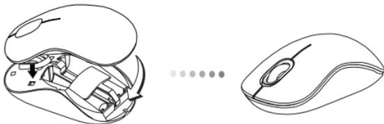
4. Sätt tillbaka batteriluckan och passa av locket försiktigt tills det klickar till och kommer på plats.
