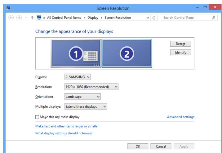
Der USB 3.0 VGA Adapter übermittelt die EDID-Daten vom Display oder Projektor so dass der Name des Displays im Fenster „Bildschirmauflösung“ unter „Anzeige“ zu sehen ist. Sie können nun die Auflösung ändern und das Display für Spiegelung (der Monitor zeigt den gleichen Desktop wie der primäre Monitor) oder erweiterten Modus (der Windows Desktop wird nach rechts, links, oben oder unten erweitert) konfigurieren. Außerdem können Sie den zusätzlichen Monitor auch noch als primären Monitor verwenden.
