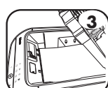
3 הוסיפו נייר. על הנייר להיות מונח בצורה חלקה ושטוחה ולהיות מיושר מול צדו הקדמי של מגש הנייר.
