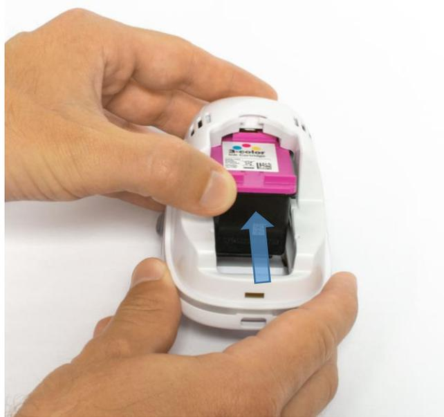
Fig. 47: Insert ink cartridge
