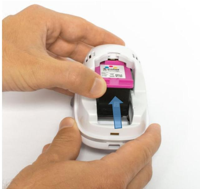
Fig. 47: Insert ink cartridge
